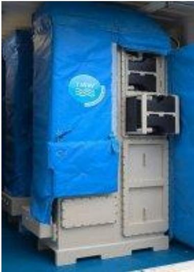
Depuis 2012, **TMW** a mis sur le marché des installations d'évaporation, sous la marque ECOSTILL, basées sur le principe de l'évaporation à pression atmosphérique et basse température (principe du cycle naturel de l'eau).
